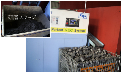
図5 工場稼働中の装置 (写真上：装置全景，下：装置から排出された再生バック)
