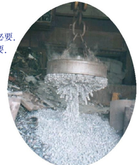
リフティングマグネットで搬送される再生バック
